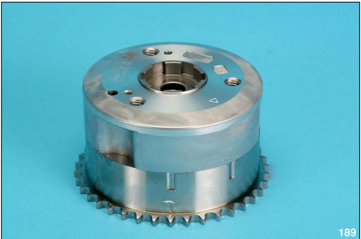
*INTAKE CAMSHAFT SPROCKET*
