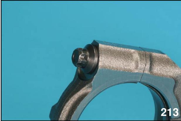
CONNECTING ROD CAP SEAM
