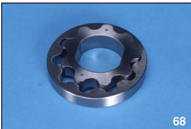
PUMP GEARS (FRONT SIDE)
