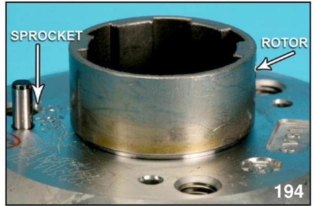
SPROCKET AND ROTOR LOCATION
